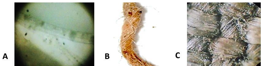
Fig.7 A- Identificación de las fibras del soporte (sección longitudinal). B- Observación al microscopio estereoscópico de la torsión en "Z" de la fibra textil. C- Macro detalle de la trama del soporte textil. Fuente: Archivo digital de los autores
