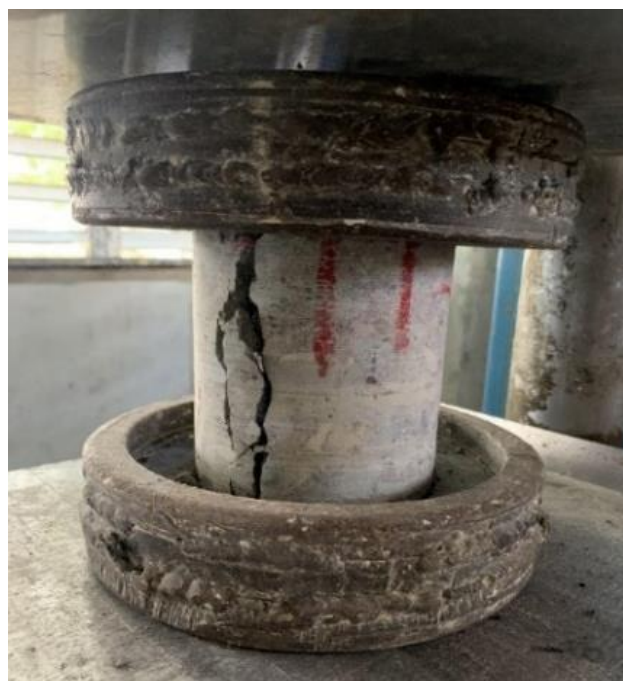
Fig. 3 Ensayo Rotura de los testigos Fuente: Fotos tomadas por el autor. Abril 24 del 2020
