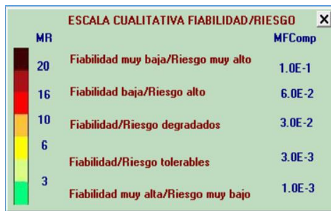
Fig. 4. Escala Cualitativa de Clasificación de Fiabilidad/Riesgo según FMEAe.
