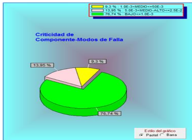
Fig. 6. Resultados obtenidos de sensibilidad en ASeC-FMEAE. Gráfico de Importancia por IRC.
