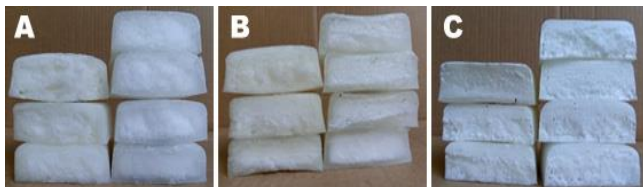
Fig. 2. Morfología de la estructura celular en la sección transversal de las bases espumadas para cada uno de los experimentos. A: PP Homo L5E89, B: PP Random RB801CF-12, C: PP Impacto 5660.
